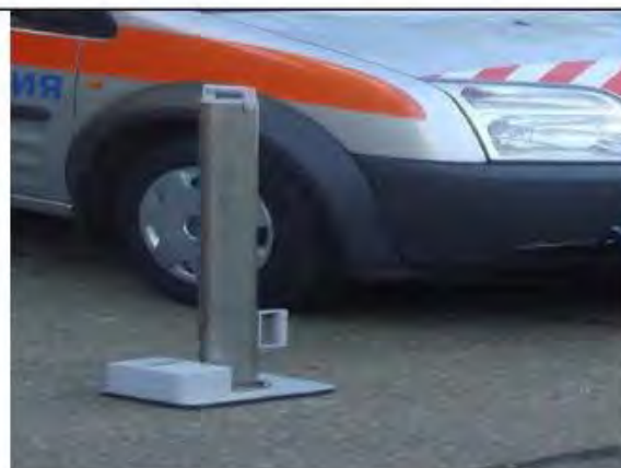
Рисунок 6 - Измеритель упругого прогиба покрытия (прогибомер)
