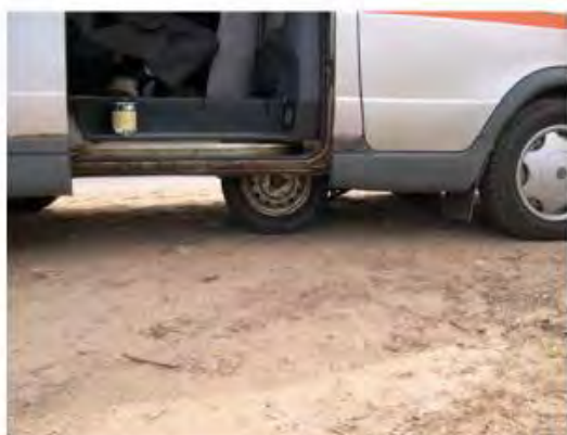
Рисунок 7 - Измеритель коэффициента сцепления покрытия
