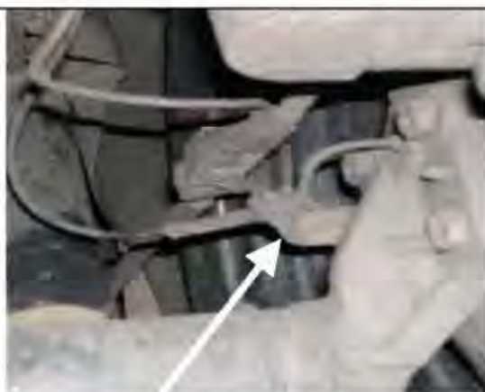
Рисунок 1 - Измеритель протяженности пути (датчик пути)
