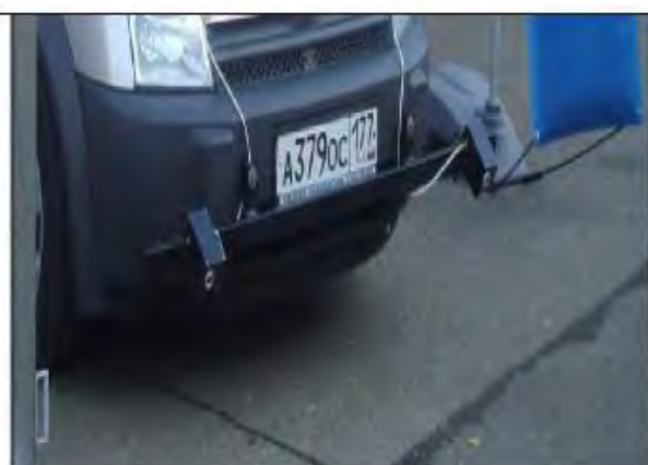
Рисунок 9 - Измеритель колеяности (лазерная сканирующая система)
