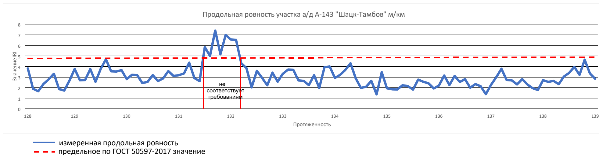
Рис. 15 График изменения продольной ровности проезжей части автомобильной дороги А-143 "Шацк-Тамбов"
