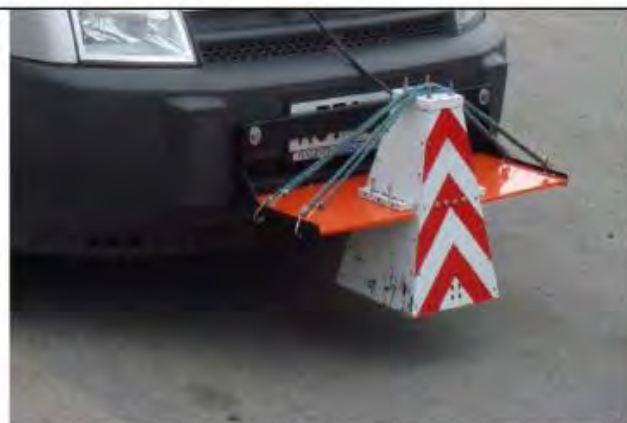
Рисунок 5 - Измеритель толщины покрытия (георадар)
